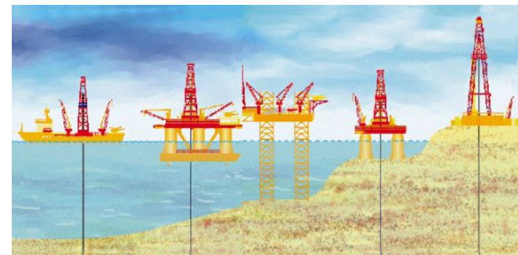
Рис. 4. Виды буровых скважин
