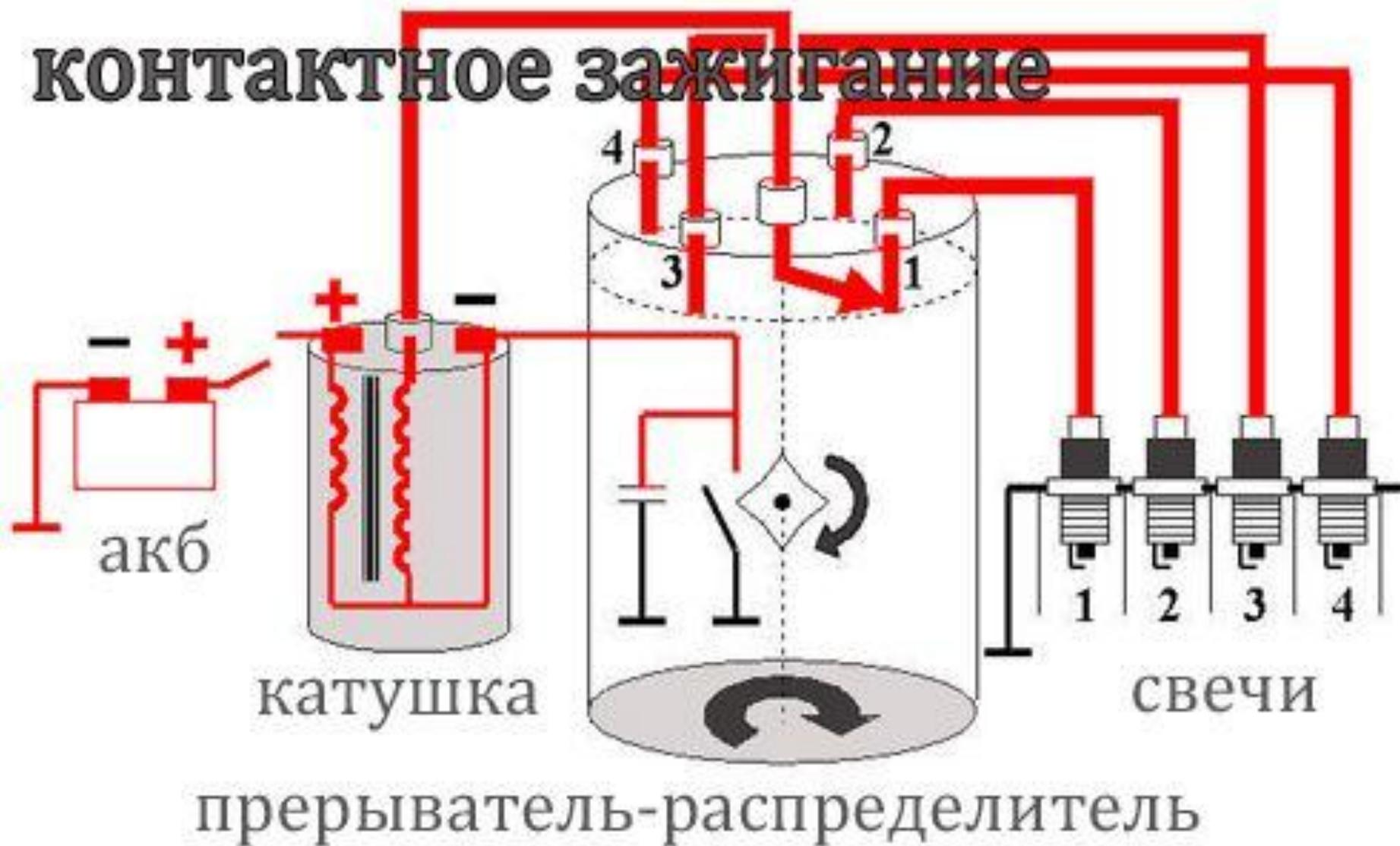
Еще раз – как едет ток низкого и как идет ток высокого напряжения ?
