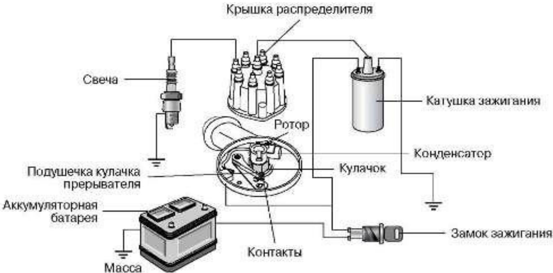
Рис. 5.8. Схема обычной неэлектронной системы зажигания
