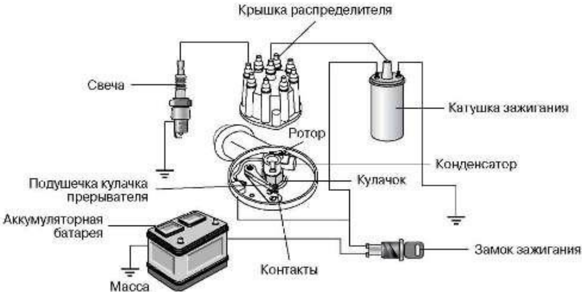
Рис. 5.8. Схема обычной неэлектронной системы зажигания
