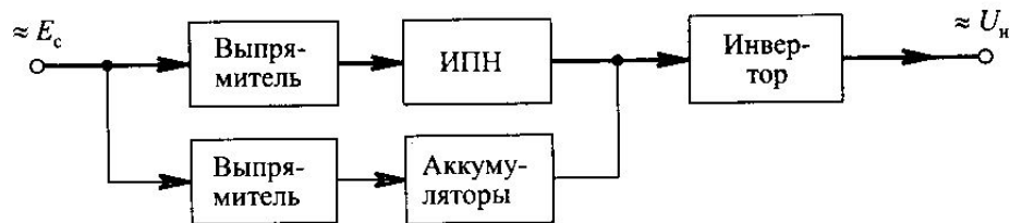
Рис. 7.3. Структурная схема ИБП типа on-line
