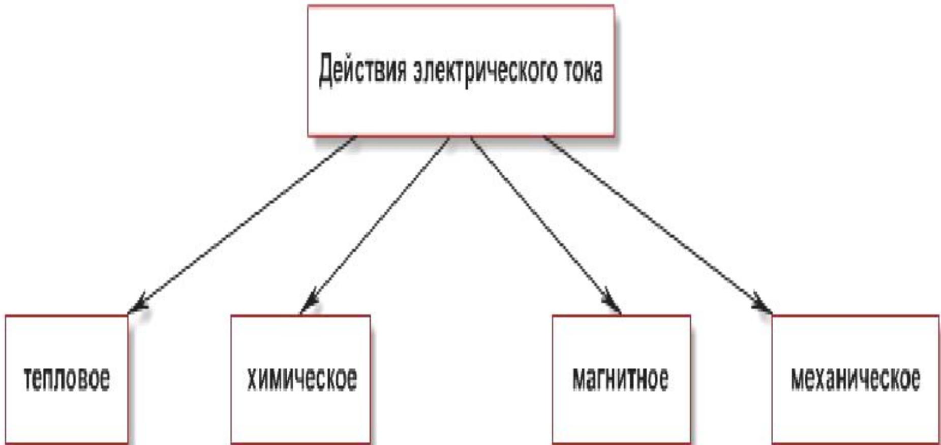
**Тепловое действие тока** заключается в нагревании проводников при протекании по ним электрического тока.
