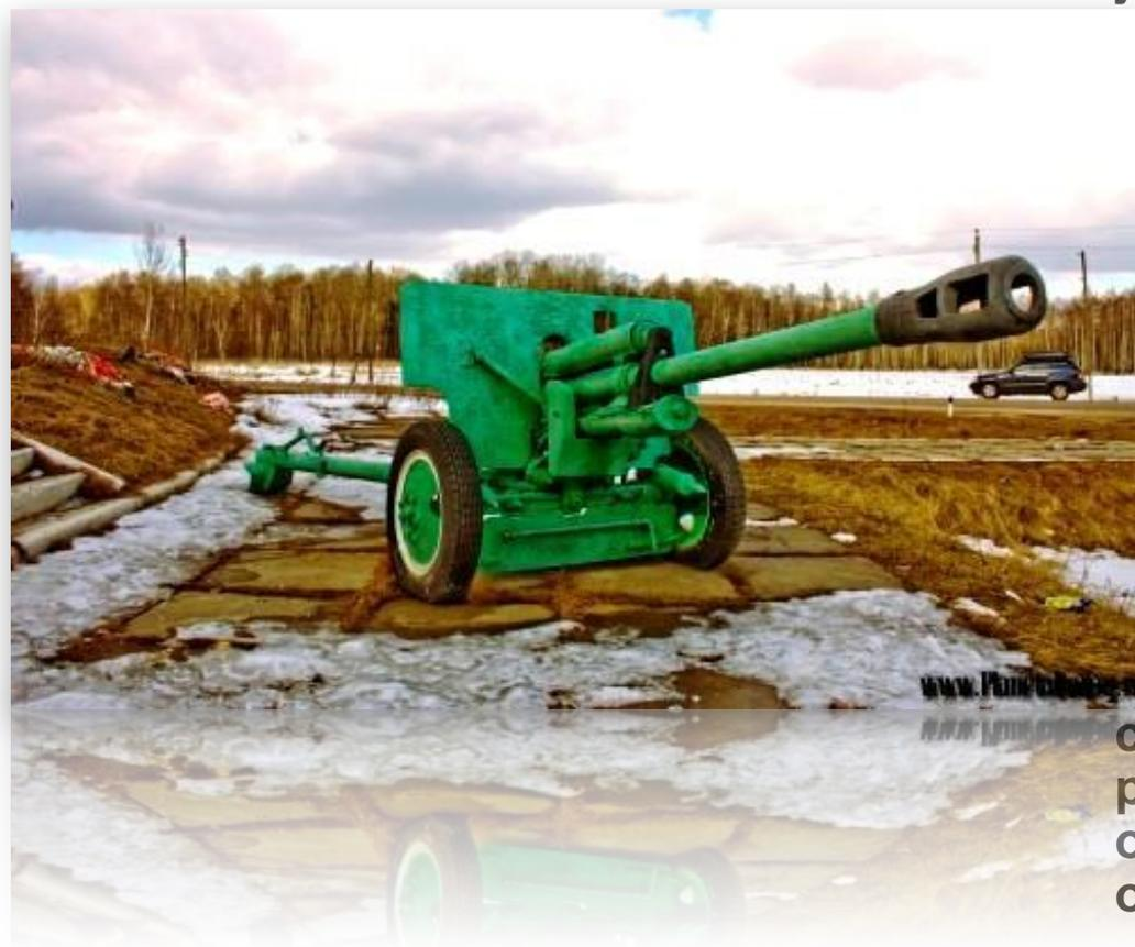
ЗИС-3 была создана путем использования прочного и легкого лафета от ротивотанковой пушки ЗИС-2 и ствола пушки Ф-22УСВ, обладавшего отличными баллистическими характеристиками и технологичностью. Для поглощения около 30-35% энергии отката ствол оснастили револьверным тормозом. Параллельно с проектированием ЗИС-3 были решены вопросы ее производства, которое, в сравнении с Ф-22УСВ, имело в 3 раза меньшие трудозатраты и на одну треть меньшую стоимость одного орудия.
