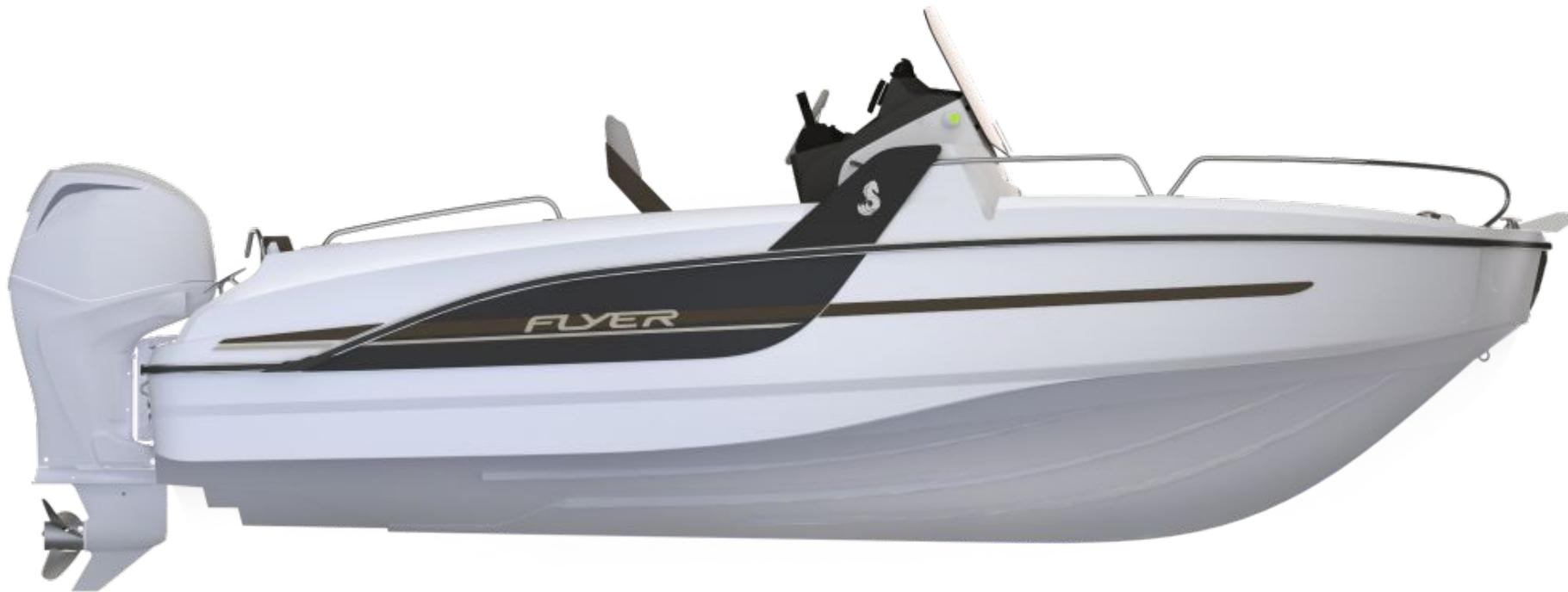
**D категория** – маломерные суда, построенные для плавания в защищенных прибрежных водах и предназначенные для плавания в защищенных прибрежных водах, небольших заливах, малых озерах и реках при силе ветра до 4 баллов и высоте волны до 0,3 метров (одиночной волны до 0,5 метров)
