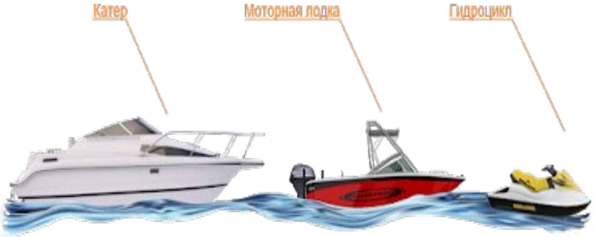
**Маломерное судно** – это водное транспортное средство общей длиной 2,5 – 24 метра (например, лодка, парусная яхта, катер и т.п.), которое используется для проведения досуга, независимо от регистрационной принадлежности....
