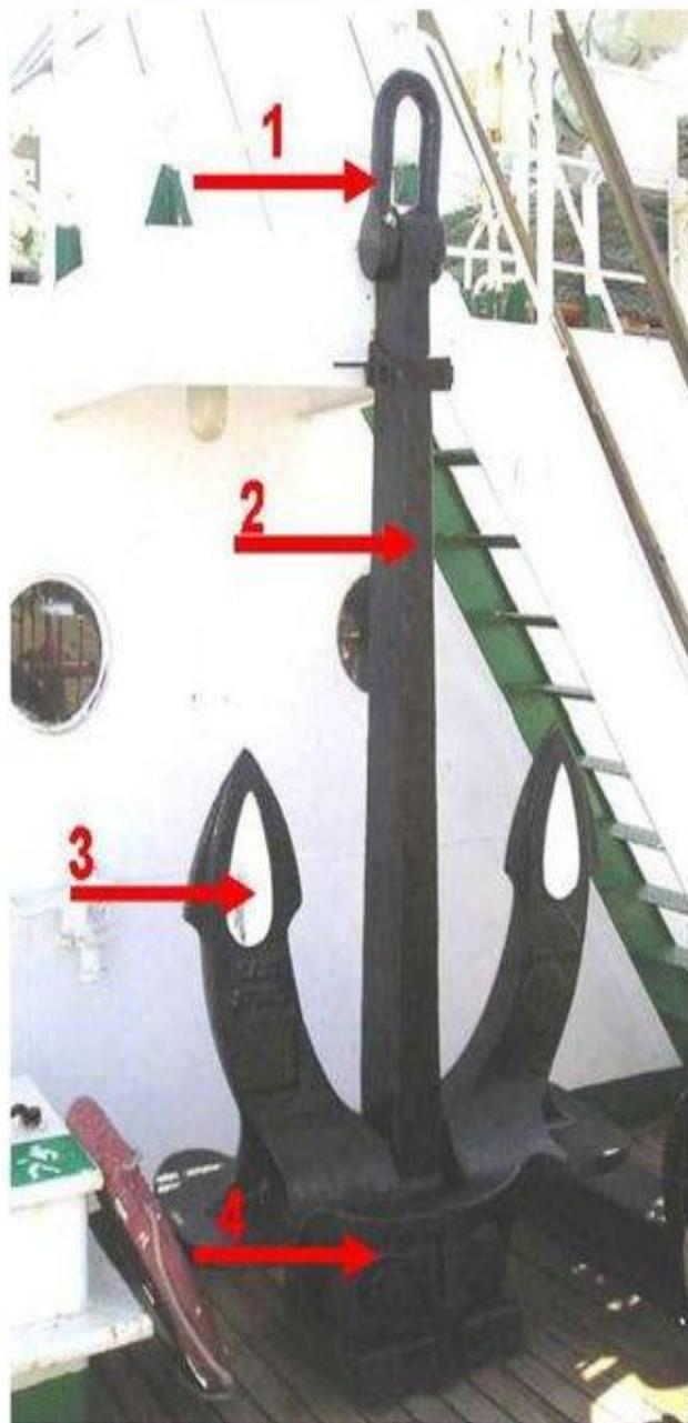
Якорь создает держащую силу, способную противостоять силе ветра и течения, зарываясь лапами в грунт. Самоходные суда имеют носовые якоря – становые и кормовой якорь – стоп-анкер
