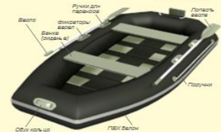
Грузы и пассажиры должны быть равномерно размещены по площади слани (пайота), таким образом, чтобы во время эксплуатации лодки сохранялся небольшой кормовой дифферент.
