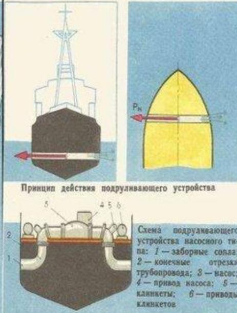
Принцип действия подруливающего устройства
