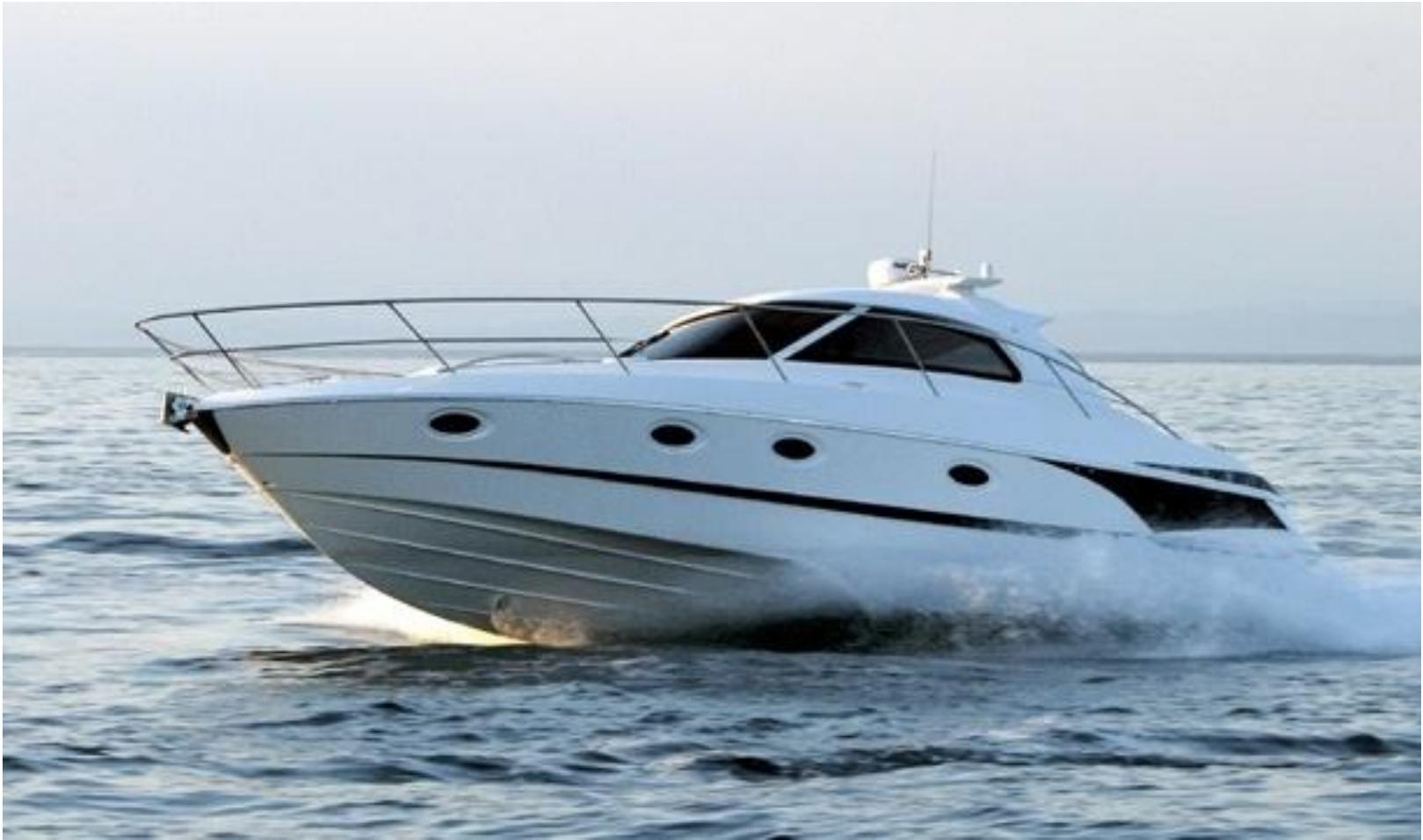
**С категория** – маломерные суда, построенные для плавания в прибрежных водах и предназначенные для использования в прибрежных водах, крупных заливах, озерах и реках при силе ветра до 6 баллов и высоте волны до 2 метров.
