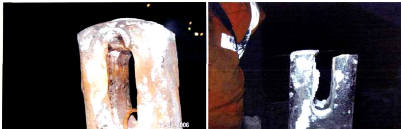
Излом хвостовика автосцепки по старой трещине
