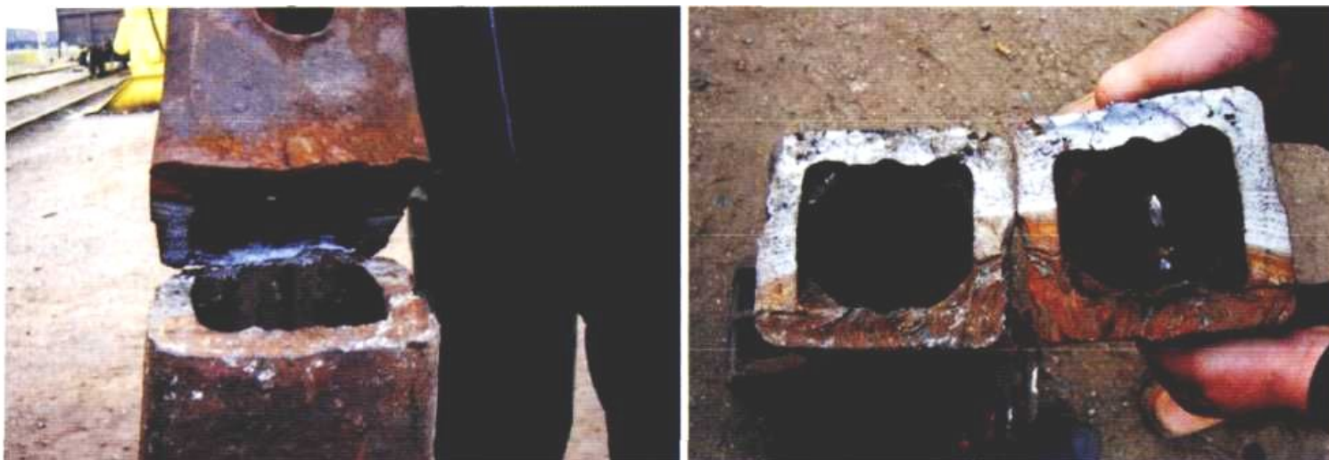
Излом хвостовика автосцепки по старой трещине
