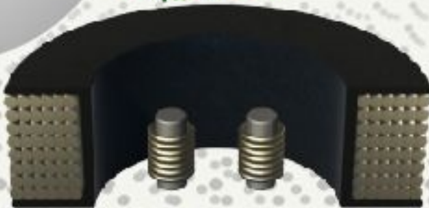
Трансформаторный ВТП с двумя измерительными катушками с сердечниками
