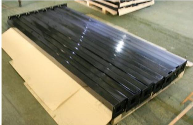
Опоры поставляются в пачках до 80 шт. на поддоне, прокладываются упаковочным материалом для предотвращения повреждения покрытия при транспортировке и увязываются лентами.
