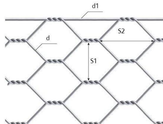
1Ц1 – горяче-цинковое покрытие с плотностью цинка 80-120 гр/м<sup>2</sup>
