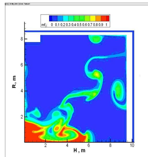
Выброс пропана при разрушении
