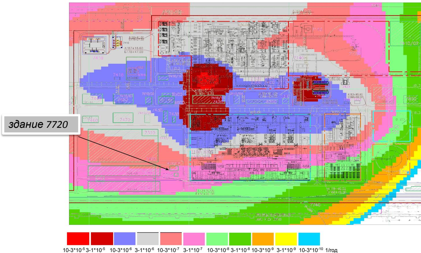
$R_{рзш}^{\Delta P_{\phi}}(x, y)$  - частота превышение давления во фронте УВ  $\Delta P_{\phi} = 12$  кПа
