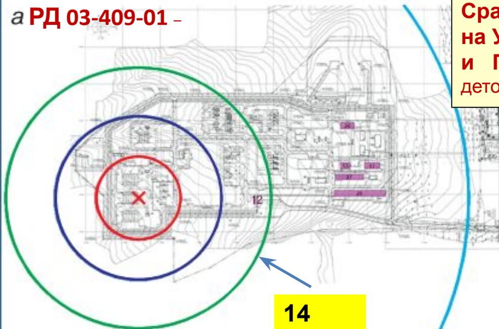
**Сравнение зон разрушения при взрыве ТВС на УПГ по РД 03-409-01 (учитывает дефлаграцию) и ПБ-09-540-03 (модель «тротилового эквивалента» детонации)**
