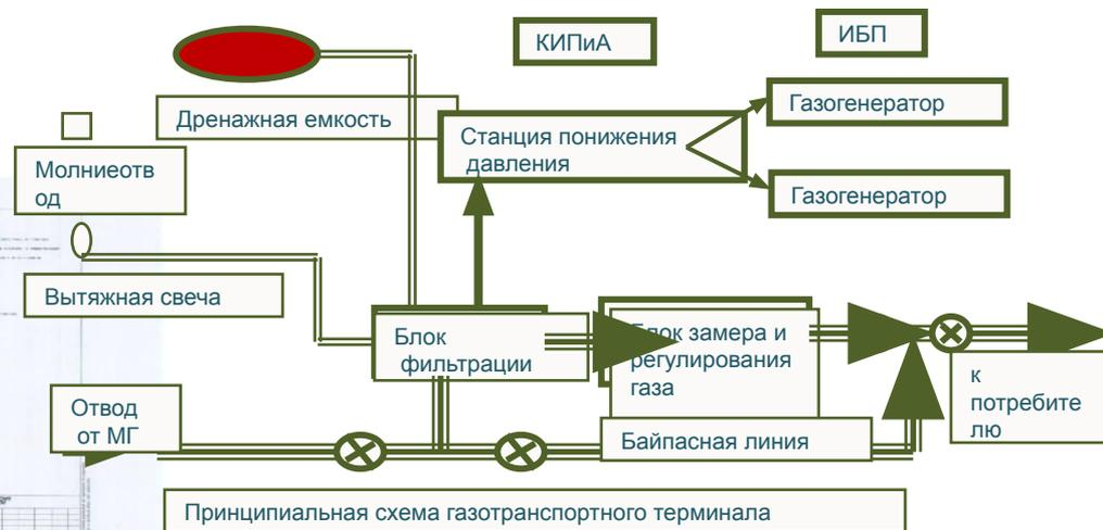
Принципиальная схема газотранспортного терминала
