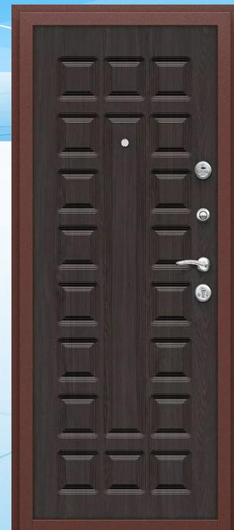
**Входная дверь класса Комфорт с наружным открыванием. Изготовлена из легированной холоднокатаной стали. Двери поставляются в правом и левом исполнении. Гладкий лист металла 1,2 мм и Панель МДФ толщиной 8 мм с отделкой ПВХ. Толщина полотна-68мм, толщина коробка-89 мм. 2 петли с подшипником 130\*20 мм. Двойной контур уплотнения по периметру полотна. Негорючая минераловатная плита. Дополнительную защиту обеспечивают противосъемные штыри (3 шт).**
