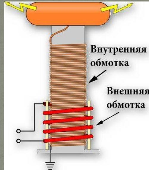
Катушка Теслы была одним из инструментов изучения природы электрического тока и возможностей его использования. Использовалось это приспособление для производства высокого напряжения высокой частоты. Тесла задействовал катушки во время проведения инновационных экспериментов в области: электрического освещения; фосфоресценции; рентгеновской генерации; высокочастотного переменного тока; электротерапии; радиотехники; передачи электрической энергии без проводов.
