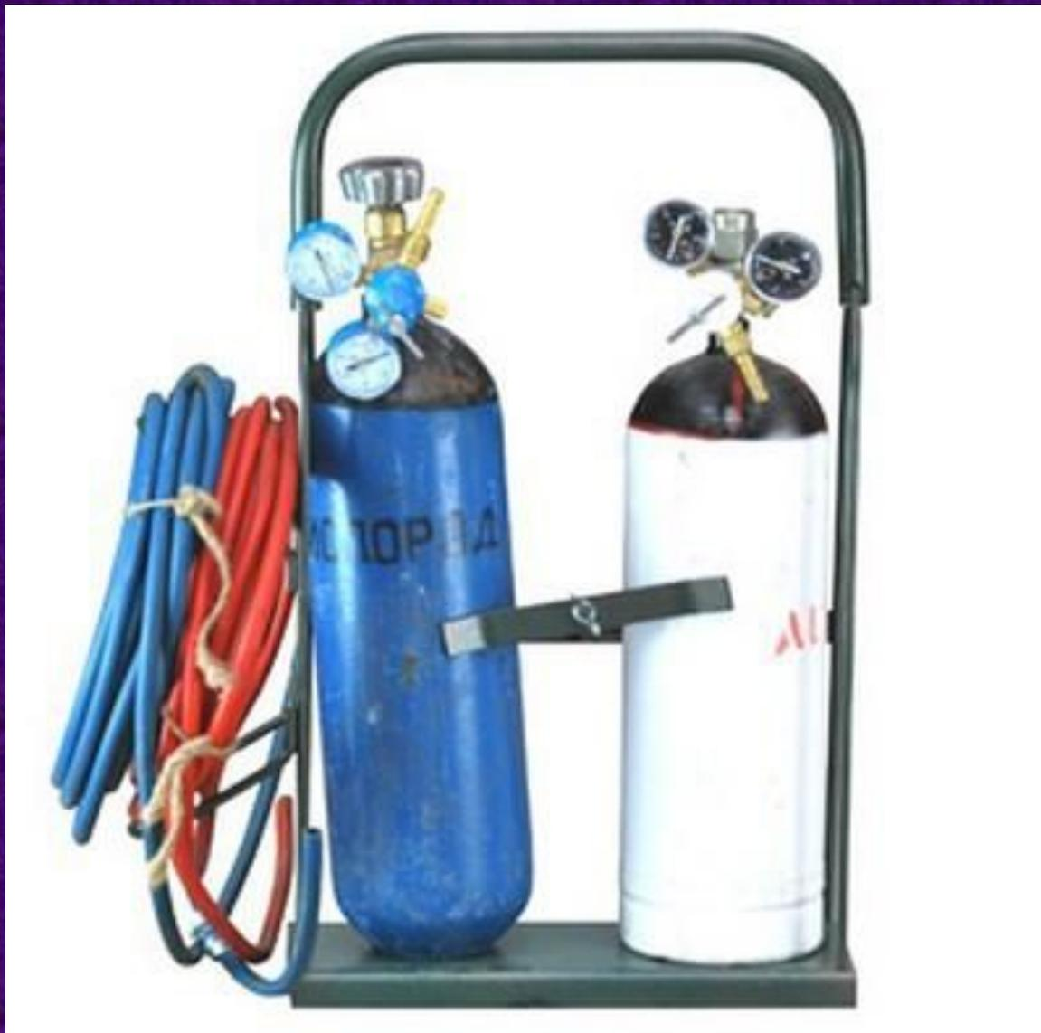
Ацетилен применяется в промышленности в качестве горючего для газовой сварки и резки металлов, а также в качестве сырья для различных химических производств.
