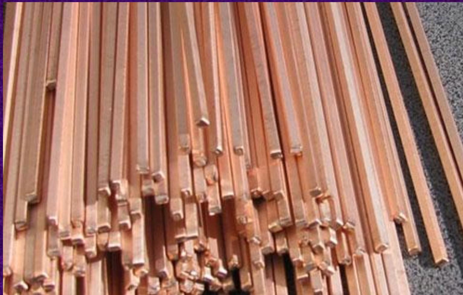
**Латуни. Широкое распространение в качестве припоев получили латуни, которые являются сплавом меди с цинком. Латуни Л62 и ЛОК-62-06-04 дают прочные паяные соединения. ЛОК-62-06-04 отличается от Л62 наличием олова и кремния, обеспечивающих более высокие технологические свойства припоя. Олово увеличивает жидкотекучесть и снижает температуру плавления, а соединения кремния предохраняют цинк от окисления и испарения. Латуни применяются при пайке меди, стали, чугуна.**
