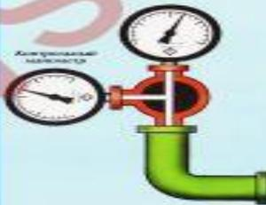
Рабочий манометр соединить с контрольным и проверить правильность показаний рабочего манометра.
