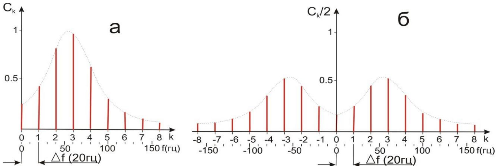
Таким образом, амплитудный частотный спектр периодического колебания - *линейчатый* или *дискретный*.
