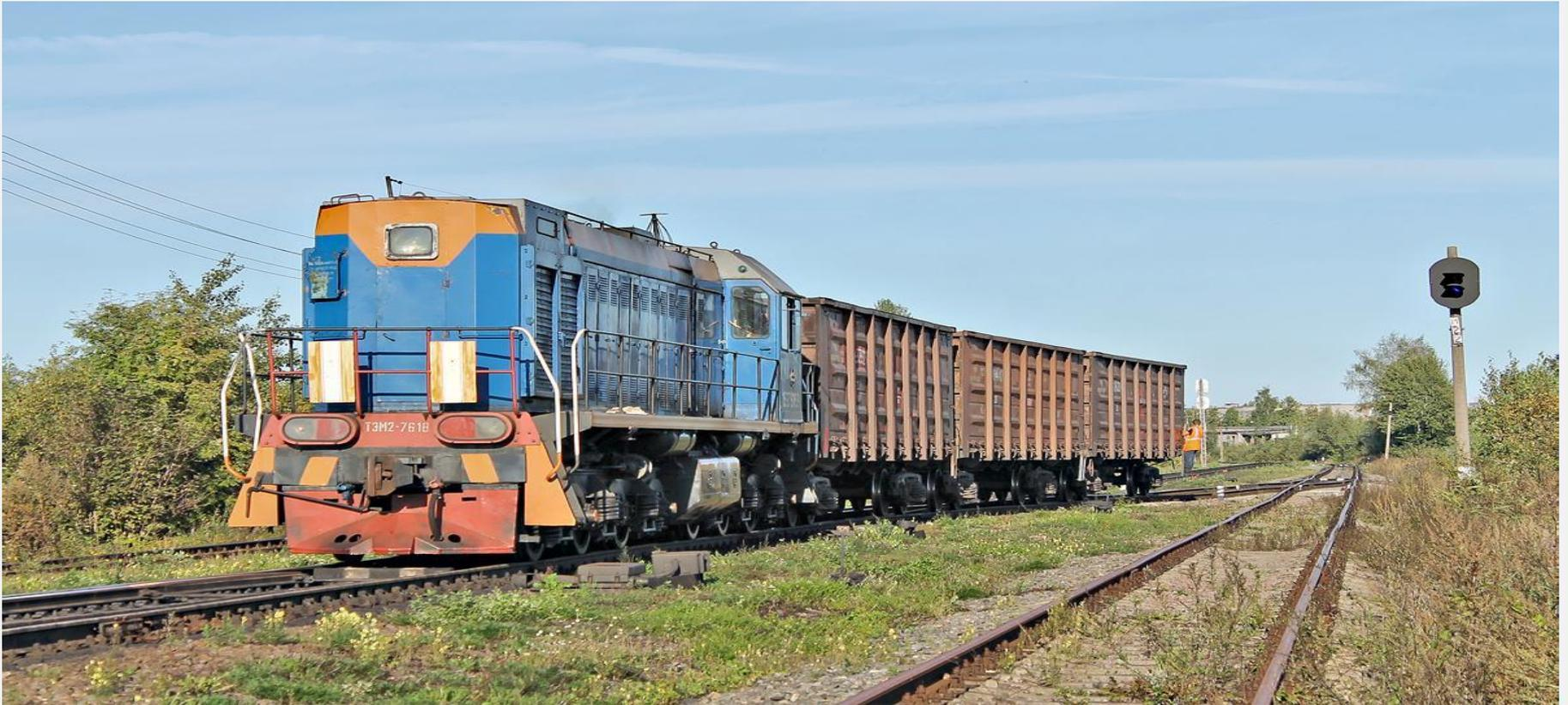
***Маневрами называются перемещения подвижного состава в пределах станции для формирования и расформирования поездов, обеспечения погрузки, выгрузки и выполнения других станционных операций с вагонами.***
