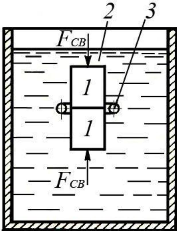
Схема диффузионной сварки в жидкой среде: 1 – соединяемые детали; 2 – жидкая среда; 3 – индуктор
