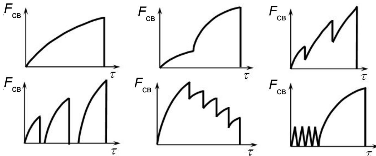
Графики изменения усилий сжатия при диффузионной сварке с принудительным деформированием
