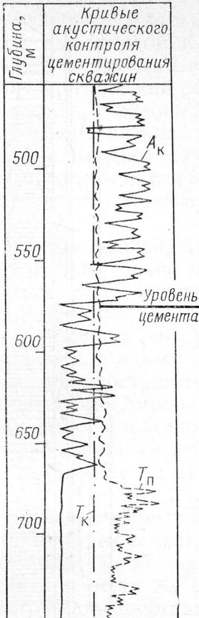
Пример определения качества цементирования обсадной колонны по данным акустического метода
