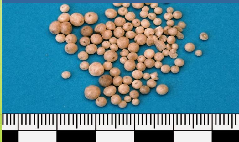
сферические гранулы от светло-желтого до темно-коричневого цвета диаметром от 1 до 4 мм с глухим отверстием
