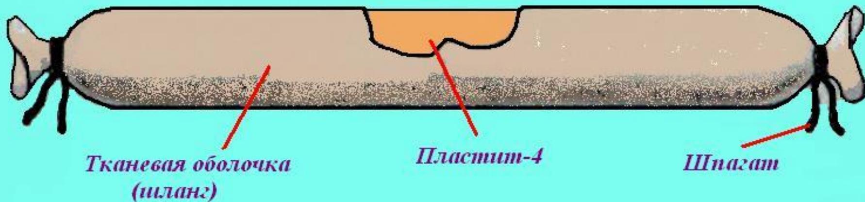
*Удлиненные заряды имеют форму вытянутых параллелепипедов или цилиндров. Высота удлиненного заряда должна быть меньше ширины*
