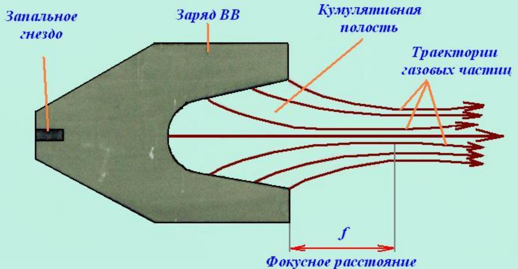
Кумулятивные заряды применяются для пробивания больших толщ броневых и железобетонных сооружений, перерезания толстых металлических листов.
