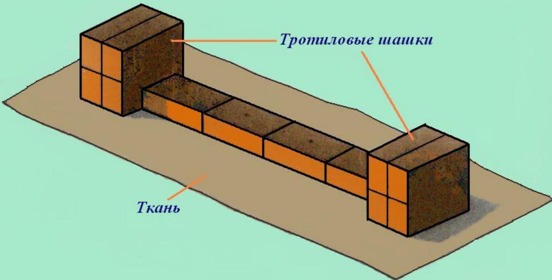
*Применяется для подрывания различных фигурных элементов конструкций*
