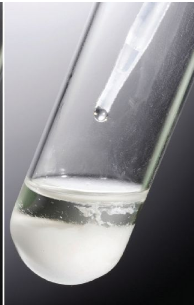
(d) Confirmation test for silver by adding \text{HCl}(\text{aq}) : \text{AgCl}(\text{s})
