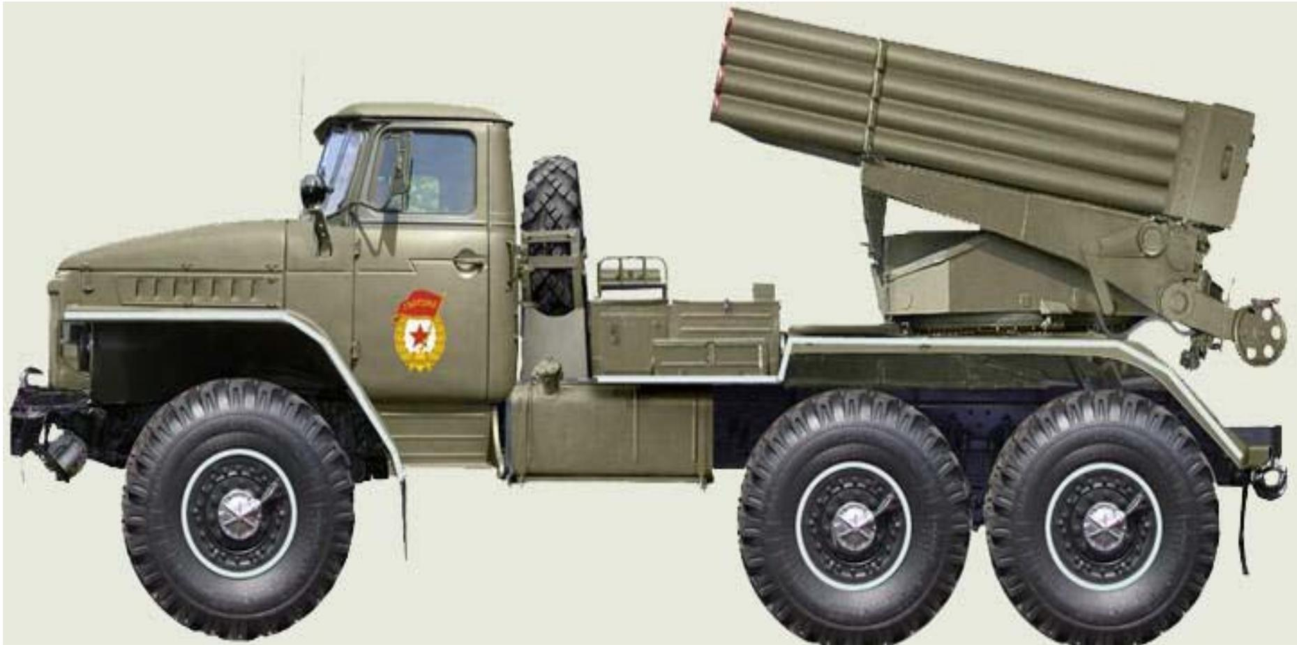
**122 -мм реактивная система залпового огня 9К51М «Торнадо -Г»
