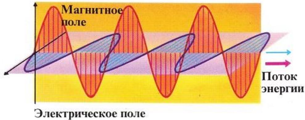
Каждый раз, когда электрический ток изменяет свою частоту или направление, он генерирует электромагнитные волны — колебания электрического и магнитного силовых полей в пространстве. Один из примеров — изменяющийся ток в антенне радиопередатчика, который создает кольца распространяющихся в пространстве радиоволн.
