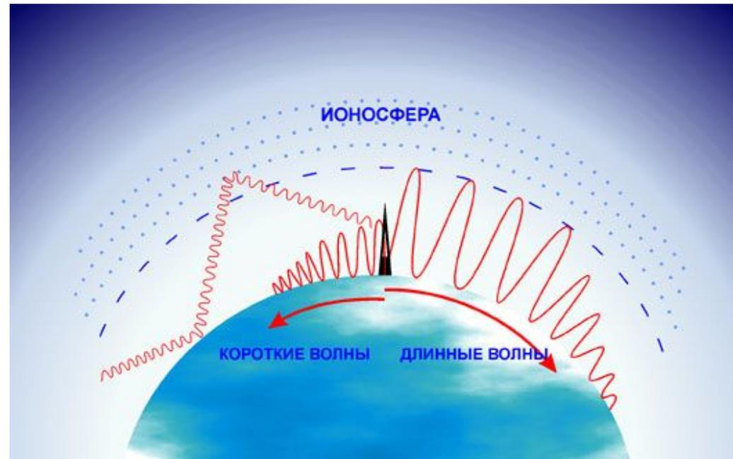
Пространственная волна, отраженная от ионосферы, может распространяться на значительно большие расстояния, чем поверхностная волна, для которой форма Земли с ее рельефом создает препятствия. Для пространственной волны наблюдается также частичное поглощение ее ионосферой и земной поверхностью при многократном отражении от ионосферных слоев.
