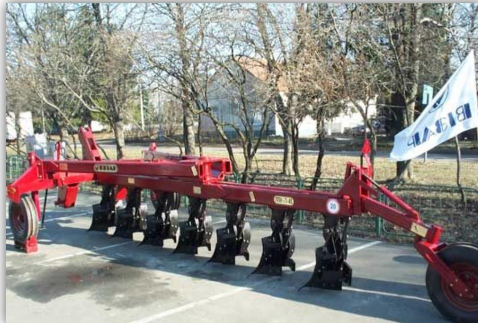
Плуг обеспечивает ровную, без отвальных и свальных борозд, вспашку на глубину до 35 см. Он имеет 7 лемешных корпусов захватом по 45 см. Ширина захвата плуга 320 см. Плуг может агрегатироваться с тракторами мощностью 200 л.с. тягового класса 5 (типа К-701).
