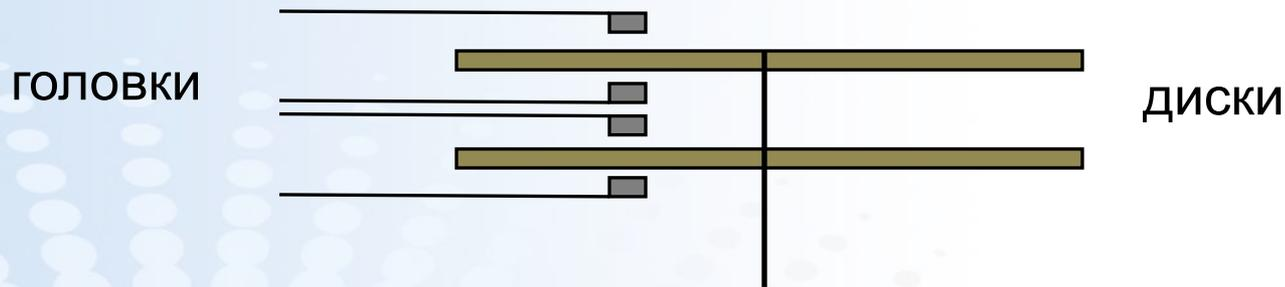
Для каждой рабочей поверхности в накопителе имеется своя **головка (head)** для записи и считывания информации. Для обеспечения возможности адресации информации на диске, головки нумеруются, начиная с нуля.
