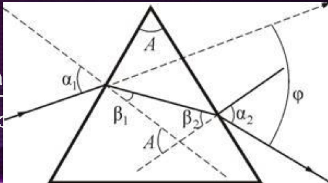
Следствием дисперсии является разложение в спектр пучка белого света при прохождении его через призму (рис. 1).
