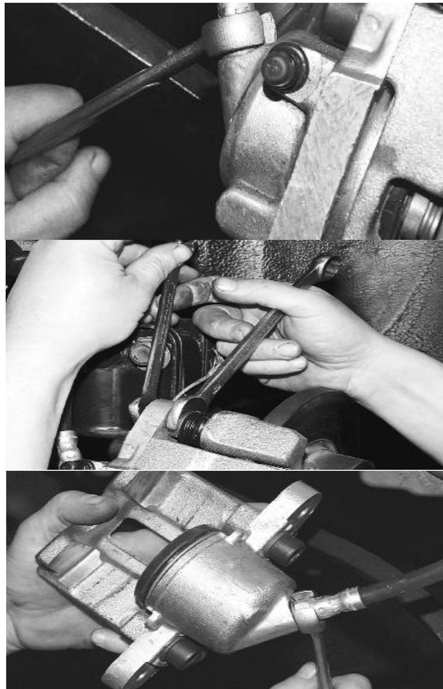
7. Зажимать суппорт в тиски и отверните два болта с внутренним шестигранником крепления цилиндра к суппорту. Снимать колесный цилиндр с суппорта.
