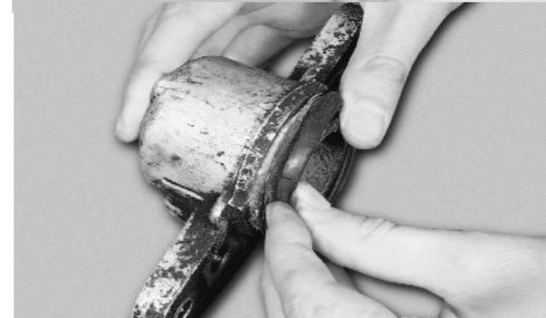
16. Вставить кромку защитного колпака в проточку поршня.
