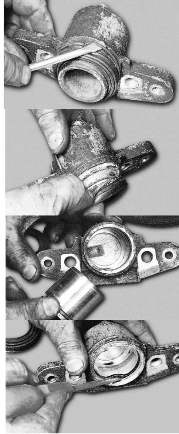
12. При необходимости замены колесного цилиндра или самого клапана вывернуть клапан прокачки.
