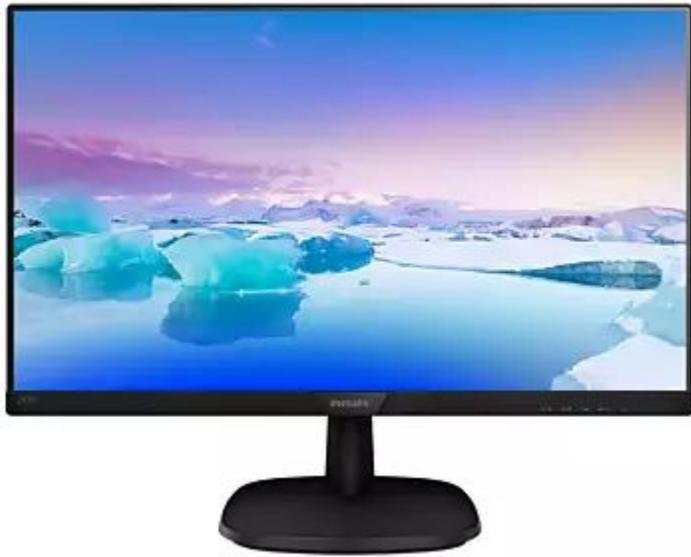
Экран подобного LCD (Liquid Crystal Display) состоит из двух стеклянных пластин, между которыми находится масса, содержащая жидкие кристаллы, которые изменяют свои оптические свойства в зависимости от прилагаемого электрического заряда. LCD нуждаются в подсветке или во внешнем освещении. Основным достоинством LCD являются их габариты (экран плоский). К недостаткам можно отнести недостаточное быстродействие при изменении изображения на экране, что особенно заметно при перемещении курсора мыши.
