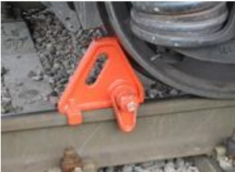
Устройство закрепления вагонов УЗ-220 предназначен для закрепления отдельных вагонов и групп вагонов весом до 1000 т на тупиковых путях станций, на железнодорожных путях необщего пользования.
