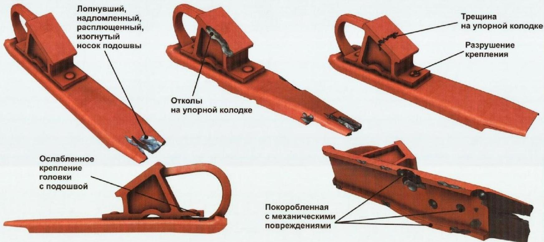
Тормозные башмаки должны быть окрашены (в цвет, при котором они более заметны), иметь установленное клеймо и храниться на специальных площадках, стеллажах и тумбочках на путях.
