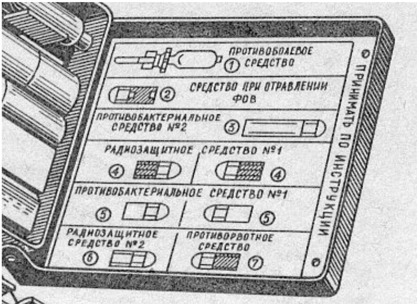
Рис. 82 Расположение препаратов в аптечке **АИ-2**
