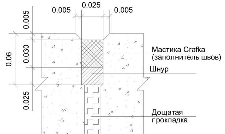
Деформационный шов с дощатой прокладкой
