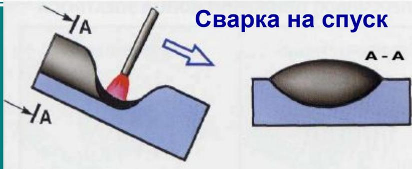
**Сварка на спуск**
