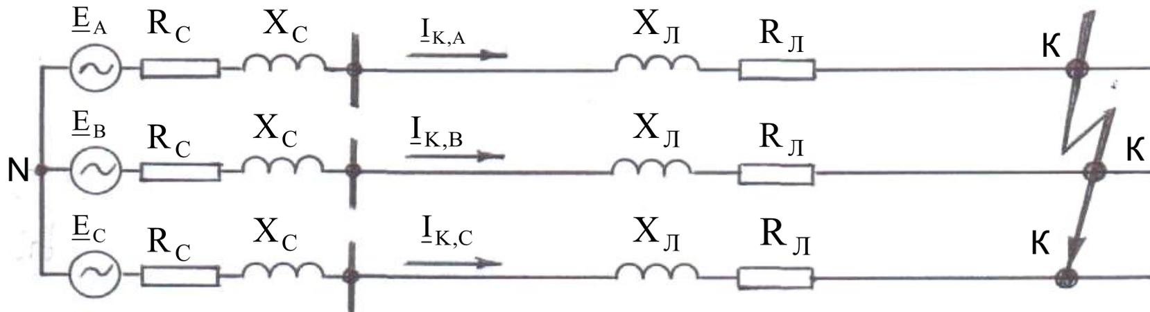
Расчётная схема замещения энергосистемы при трёхфазном КЗ
