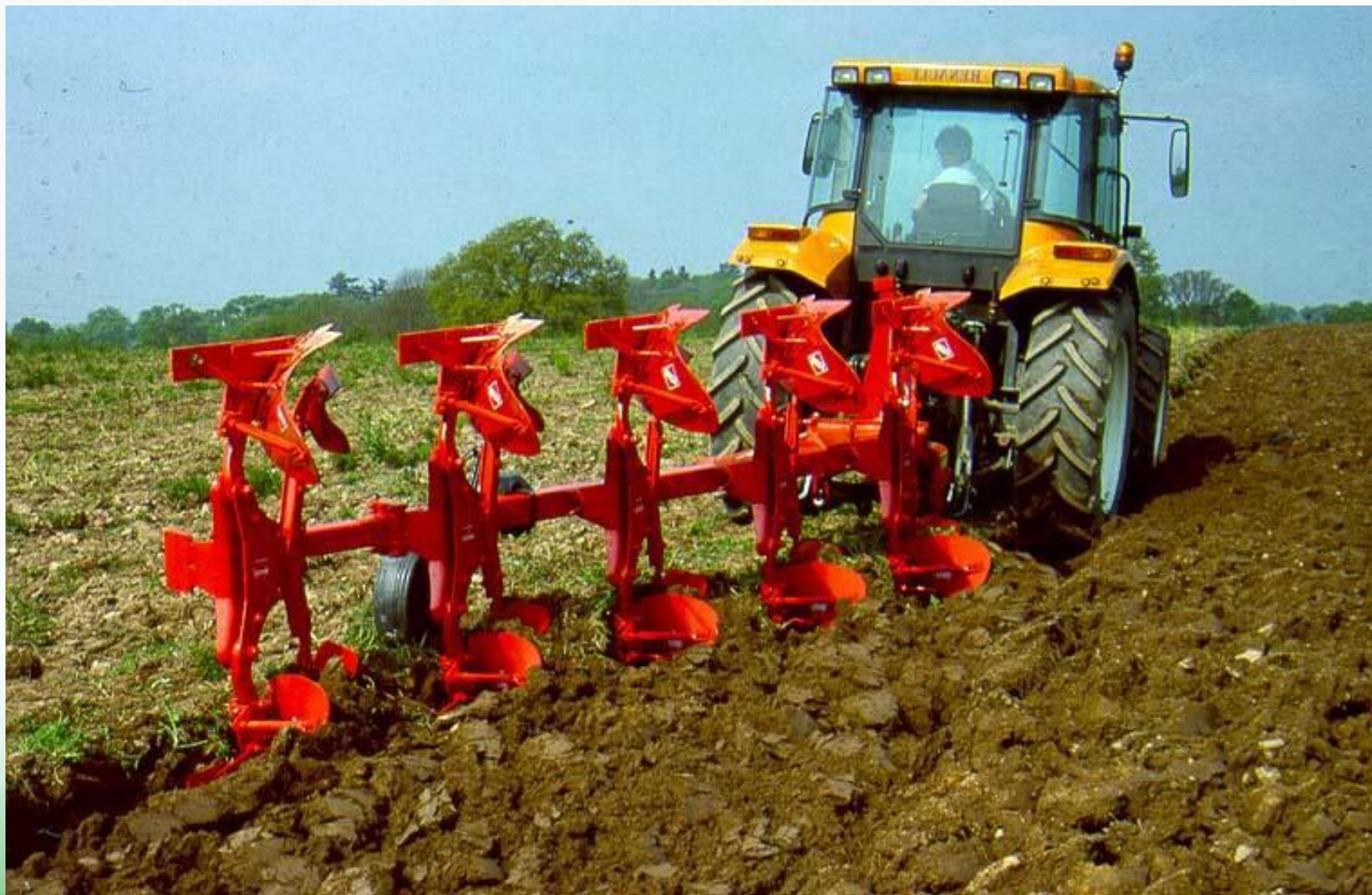
Трактор с плугом. Плуг переворачивает земляной пласт
