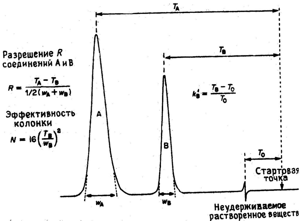
Каждое соединение при данном наборе рабочих условий имеет определенное время удерживания (объем удерживания)
