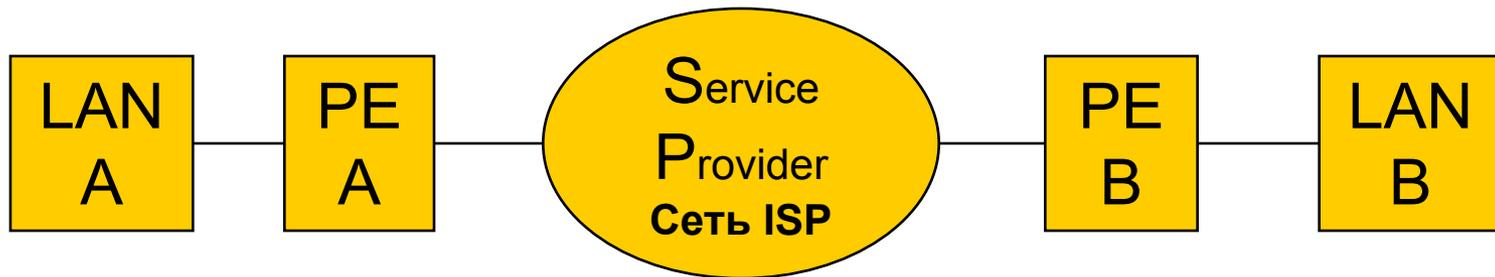
**PE:** Provider Edge – окончное оборудование провайдера
