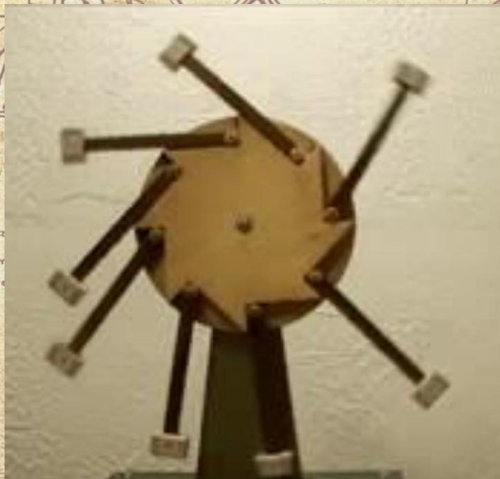
**Несмотря на то, что по принципу действия машина Вийяра сходна со схемами, предложенными арабскими учёными ранее, отличие заключается в том, что вместо сосудов со ртутью или сочленённых деревянных рычагов Вийяр размещает по периметру своего колеса 7 небольших молоточков.**
