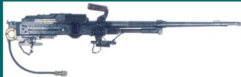
ПКТ – 7,62 мм пулемет Калашникова танковый
