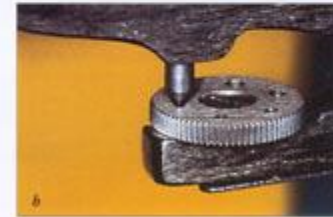
Рис. 23. Зубец должен быть установлен на точном центре выбранной отверстия резжурки стола
