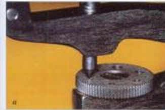
Рис. 23. Зубец должен быть установлен на точном центре выбранной отверстия резжурки стола
