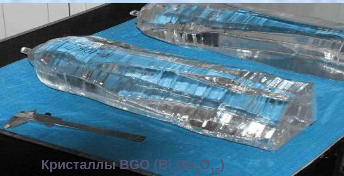
Кристаллы BGO ( $\text{Bi}_4\text{Ge}_3\text{O}_{12}$ )
