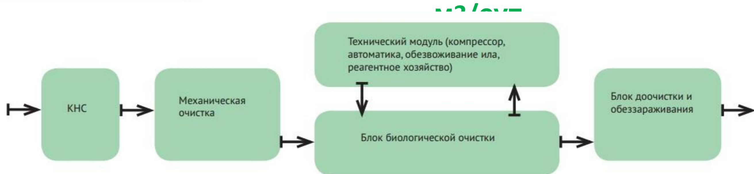
Тип исполнения: надземное в контейнерах, подземное в герметичном стеклопластиковом или металлическом корпусе.
