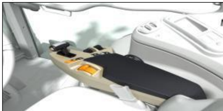
Компоновка органов управления в версии Efficient с Т-образным рычагом
