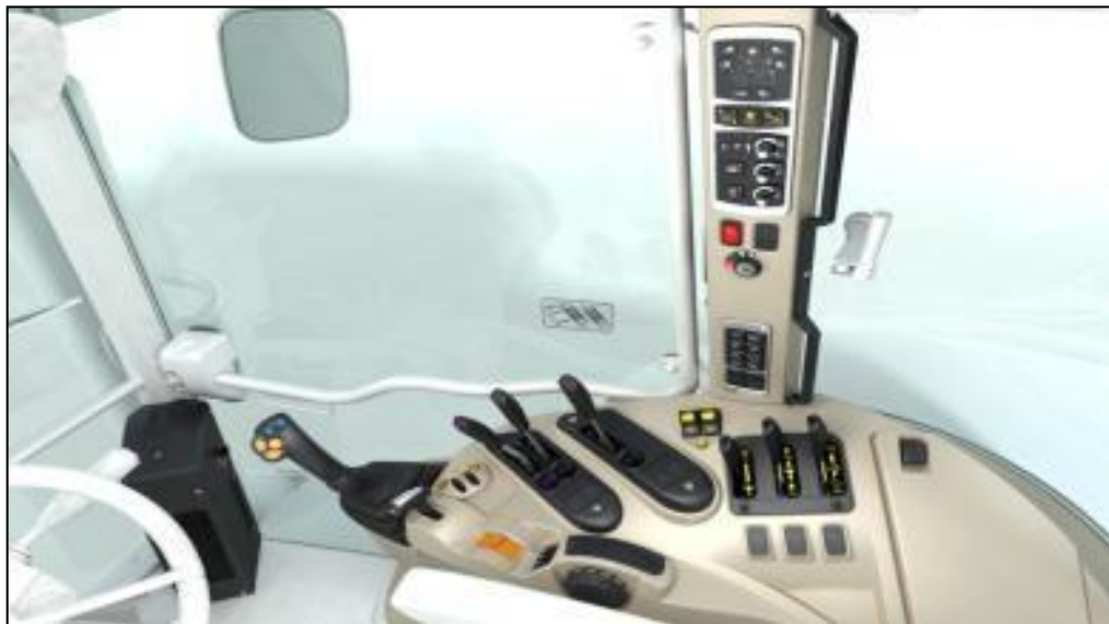
Интерьер кабины в версии Essential с установленным механическим джойстиком
