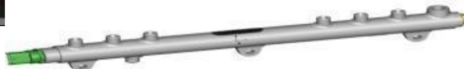
Топливная рампа системы Common Rail
