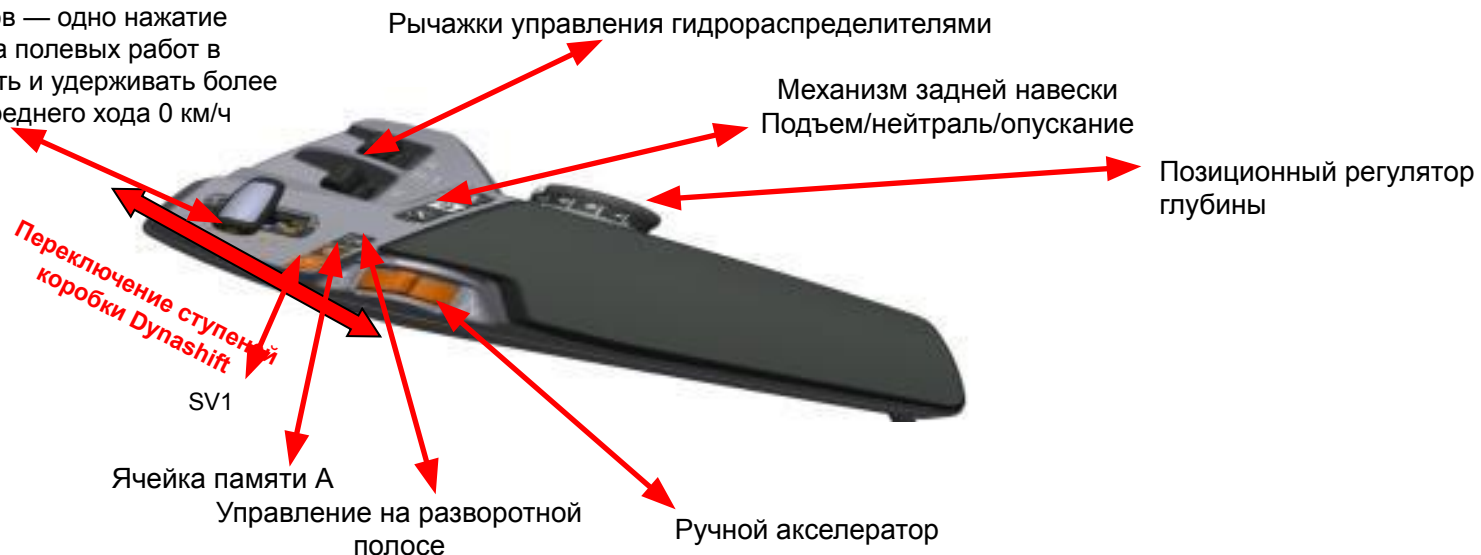
Компоновка органов управления в версии Efficient с Т-образным рычагом
