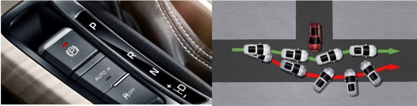
**Система ESP (Electronic Stability Program)** – это фактически система контроля тягового усилия. По сравнению с другими системами контроля тяги ESP может управлять не только ведущим колесом, но и управляемыми колесами:
