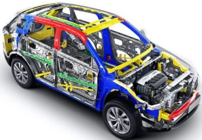
Конструкция кузова Geely Atlas создана с применением высококачественной стали, обладающей повышенной прочностью.
