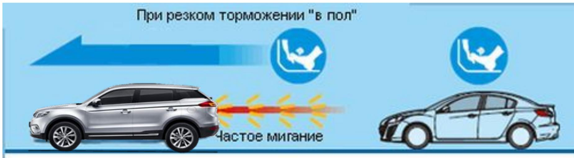
Под аббревиатурой ESS скрывается специальная система, предназначенная для информирования водителей идущих следом машин об экстренном торможении. При работе системы ESS у автомобиля начинают мигать стоп-сигналы или поворотники (как при аварийном режиме).
