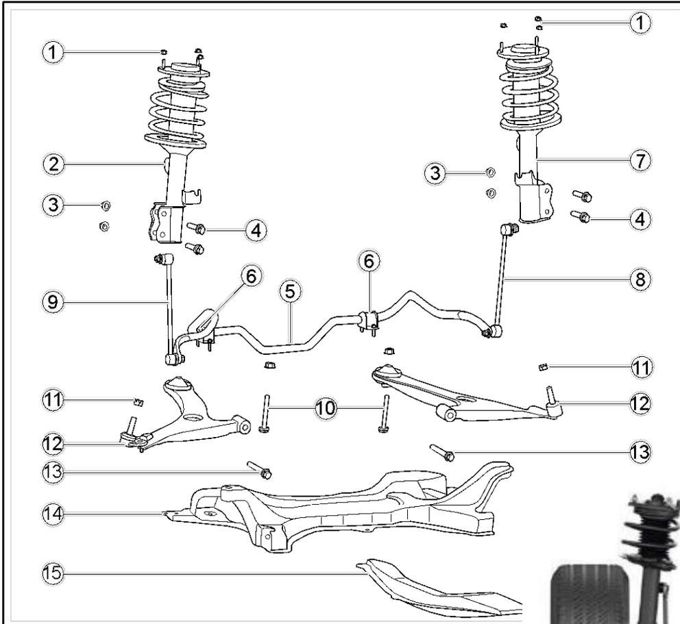
Данный тип подвески широко используется для автомобилей с поперечным расположением двигателя. Подвеска МакФерсон состоит из:
