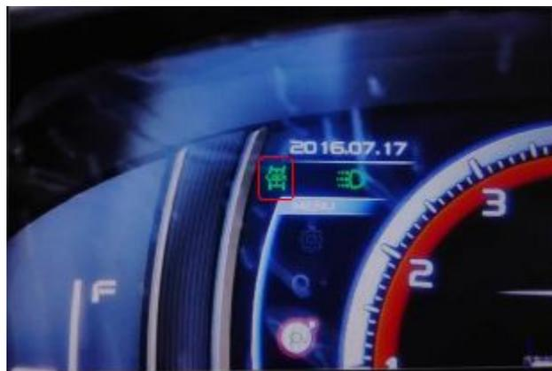
на комбинации приборов. Это означает, что эта функция включена, и автомобиль вступил в принудительный режим полного привода. Пока автомобиль в режим «4WD LOCK», не рекомендуется движение по сухой асфальтированной дороге, а также совершение длительного поворота под большим углом, иначе соответствующий компонент системы полного привода будет поврежден, и могут возникнуть шум или вибрация.
