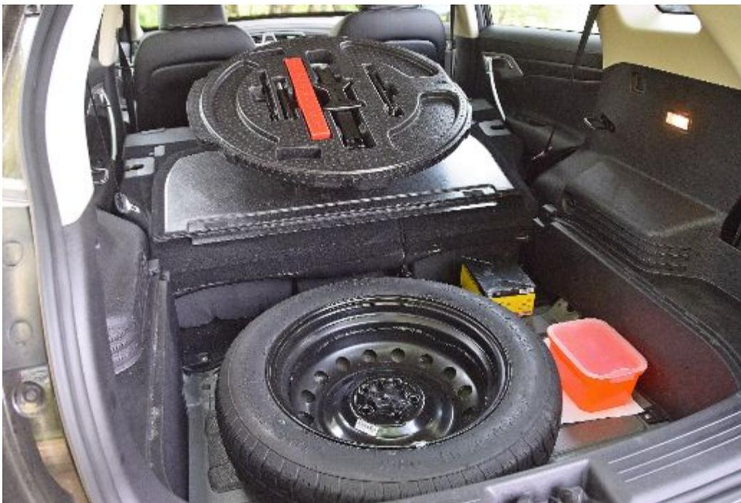
В случае прокола шины или повреждения колеса в каждой комплектации доступно неполноразмерное запасное колесо, домкрат и баллонный ключ.
