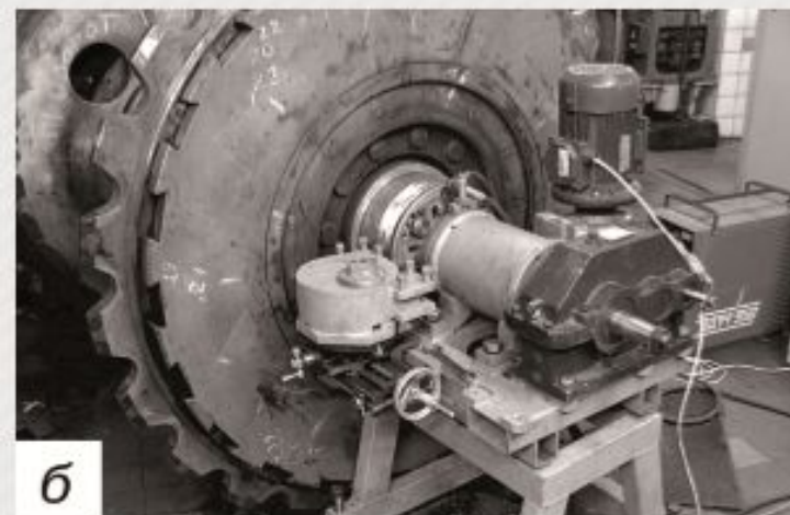
Наплавка (а) и механическая обработка (б) посадочного места вала на УД-690
