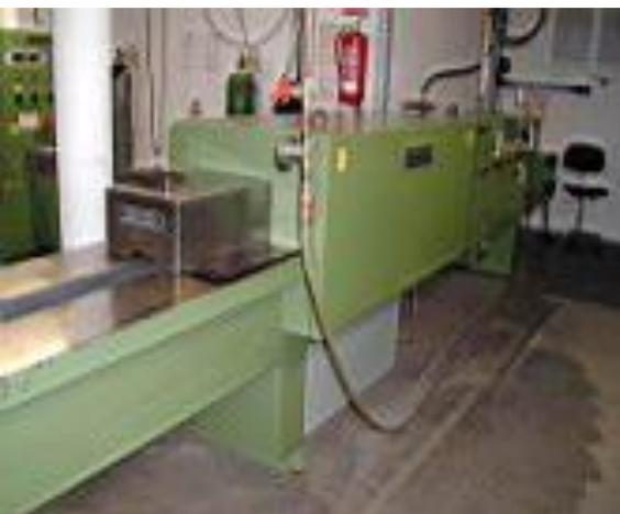
Один из финальных этапов - медленное разогревание инструментов до 400 градусов и затем их медленное остывание - примерно в течение 10 часов. Мягкая, пластичная сталь становится более твердой, прочной.
