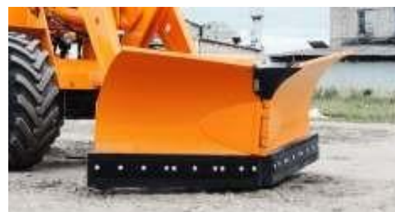
Отвал с изменяемой геометрией
