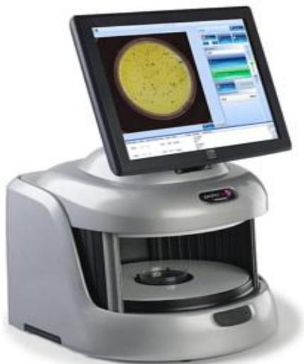
Прибор для автоматического измерения зон задержки роста бактерий
