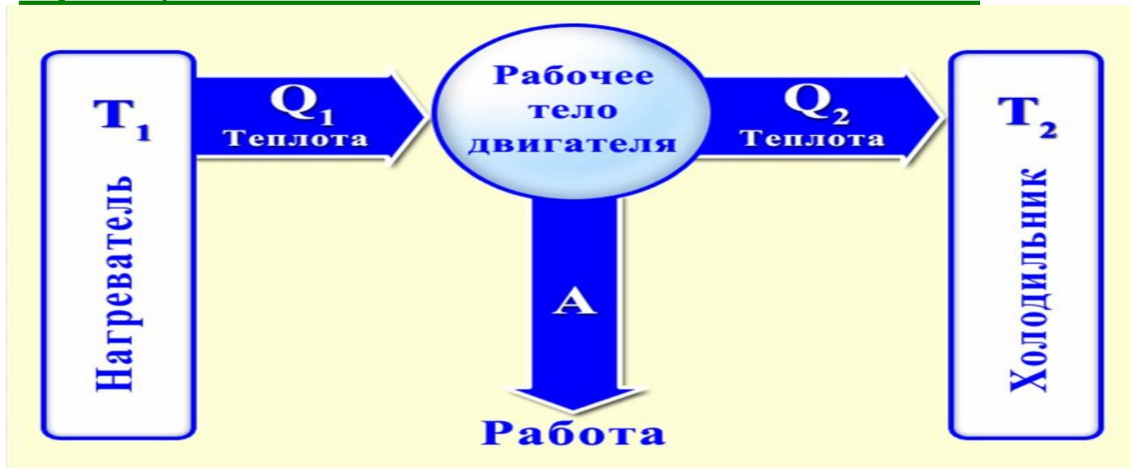
Нагреватель с температурой  $T_1$  передает рабочему телу в ходе его расширения количество теплоты  $Q_1$  без изменения температуры.
