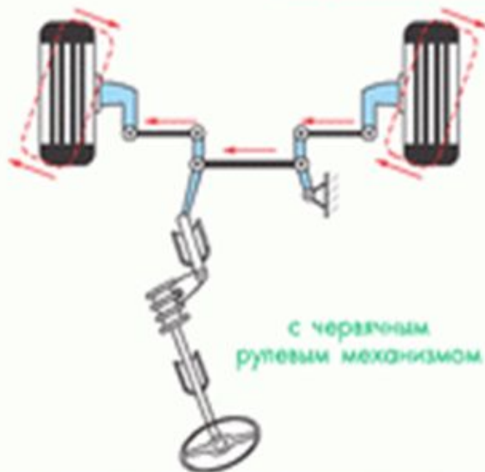
Рулевой привод с разрезной поперечной тягой
