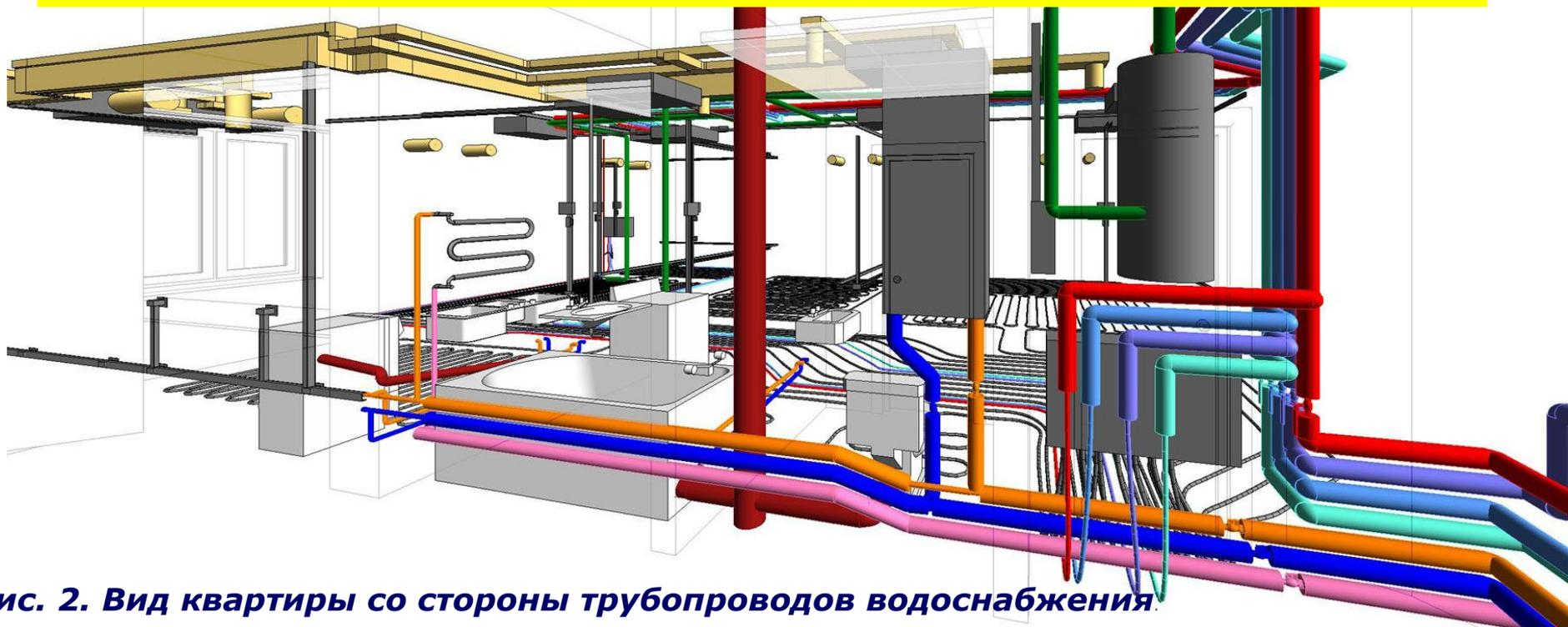
**Рис. 2. Вид квартиры со стороны трубопроводов водоснабжения.**
