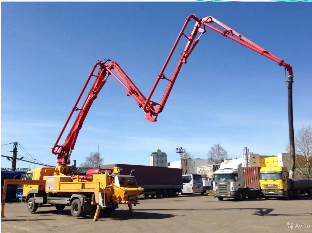
**Автобетононасосы предназначены для подачи свежеприготовленной бетонной смеси с осадкой конуса 6...12 см в горизонтальном и вертикальном направлениях к месту укладки при возведении сооружений из монолитного бетона и железобетона. Отечественные автобетононасосы оборудуются двухцилиндровыми гидравлическими поршневыми бетононасосами.**
