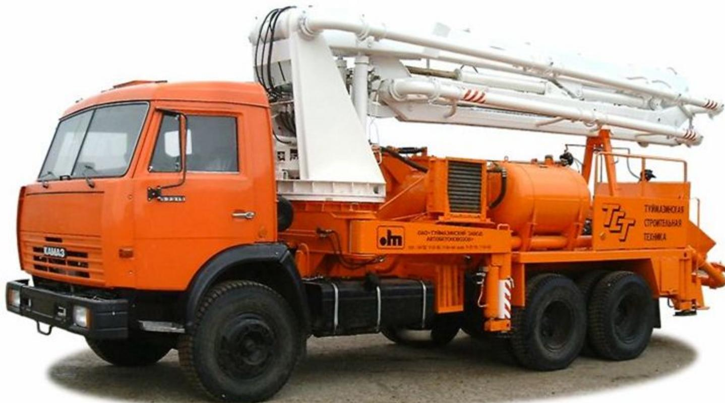
**Автобетононасосы** представляют собой самоходные мобильные бетонотранспортные машины, состоящие из базового автошасси, бетононасоса с гидравлическим приводом и шарнирно сочлененной стрелы с бетоноводом для распределения бетонной смеси в зоне действия стрелы во всех ее пространственных положениях.
